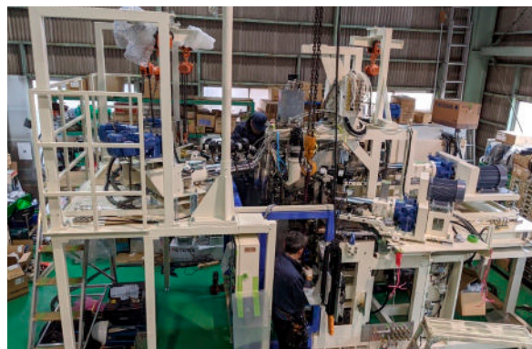
6種9層の積層ブロー成形機
